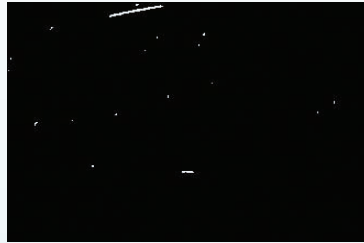
Figure 7 Imagen binarizada de una región con imperfecciones (179 Píxeles Blancos)
