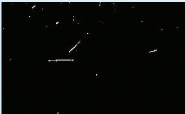
Figura 6. Imagen Binarizada de una región con muchas imperfecciones (245 Píxeles Blancos).
