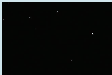
Figure 8 Imagen binarizada de una región sin imperfecciones (13 Píxeles Blancos).
